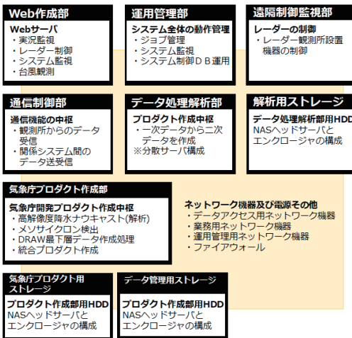
図3 処理系のシステム概要
