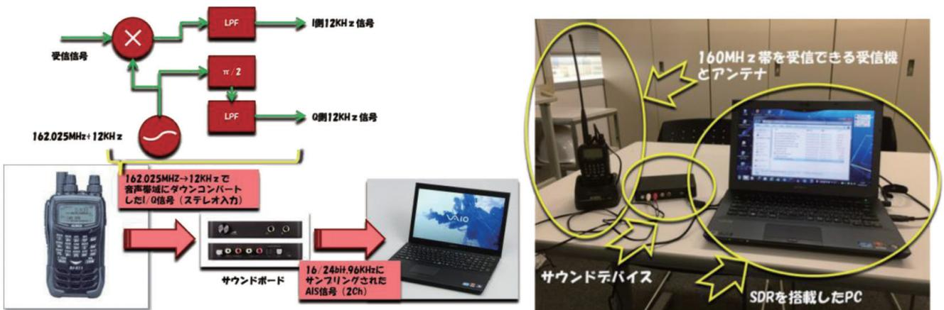
図6 AIS信号受信システム
