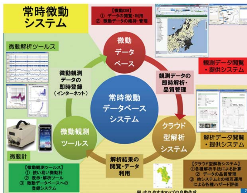
図6 常時微動システムの概要
