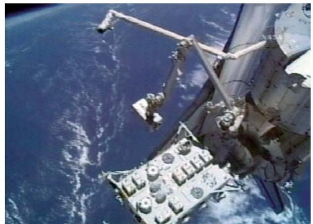
図2 ペイロード移設中のJEMRMS (JAXA HP<sup>(1)</sup>より)
