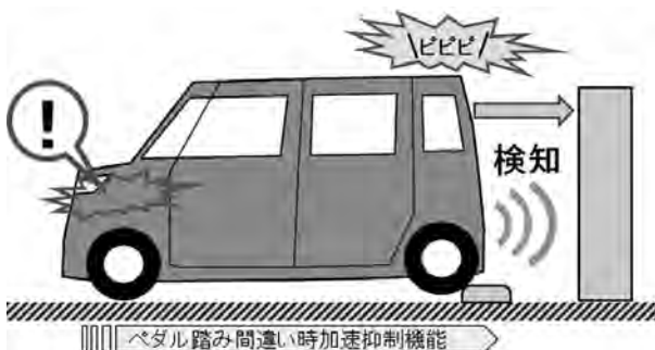
図2. (後方)ペダル踏み間違い時加速抑制機能
