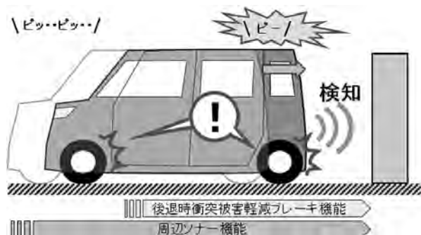
図1. 後退時衝突被害軽減ブレーキ機能及び周辺ソナー機能
