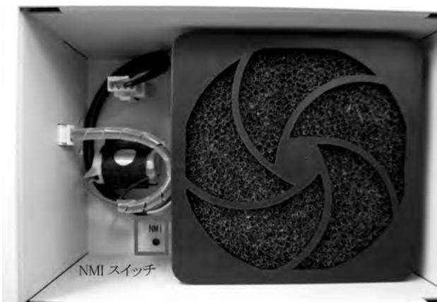
図4. NMIスイッチ(ファンカバー取り外し状態)
