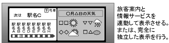
図5. 2画面一体型メディア表示器による表示例
