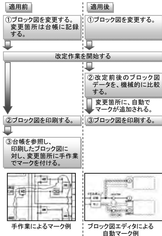
図13. 変更点抽出作業の効率化
